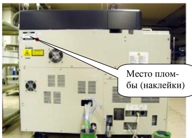
Рисунок 2 – Расположение пломбы (наклейки) Анализатор автоматический биохимический Bio Majesty JCA-VM6010/C.
