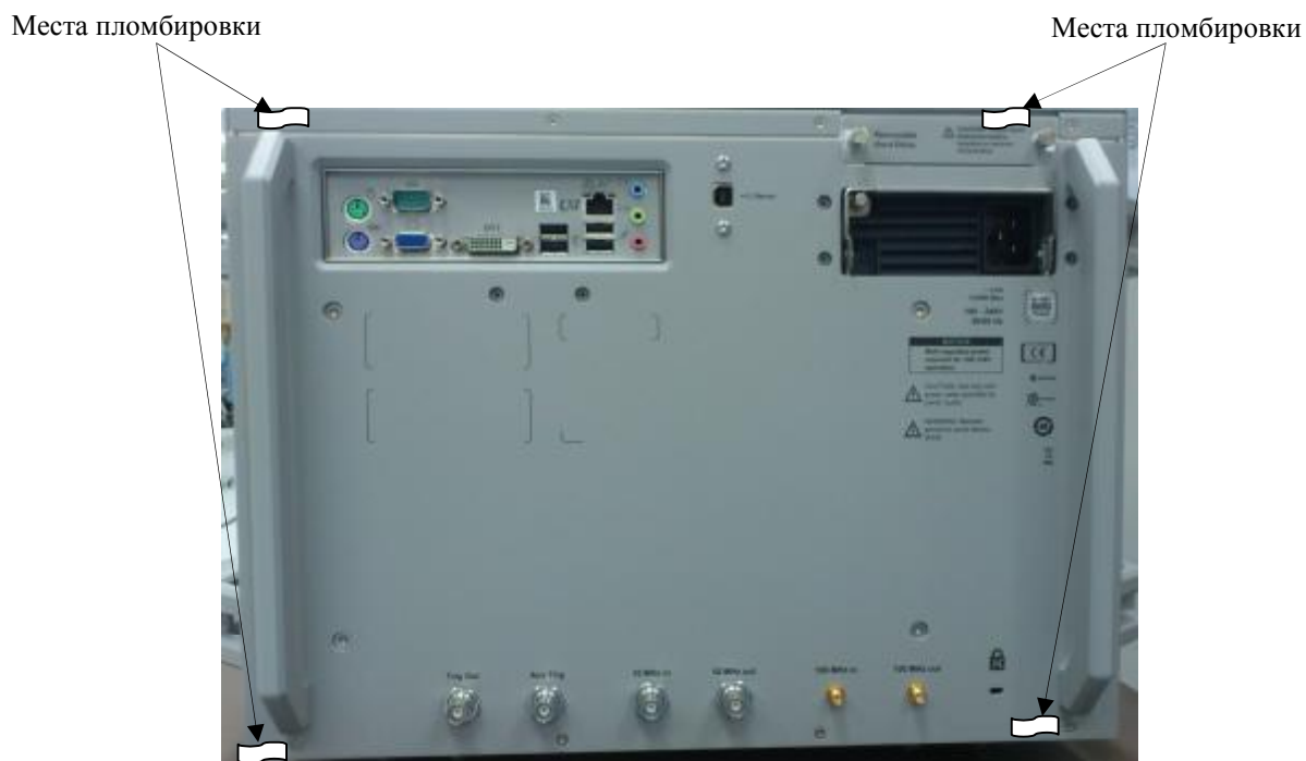
Рисунок 2 - Схема пломбировки от несанкционированного доступа
