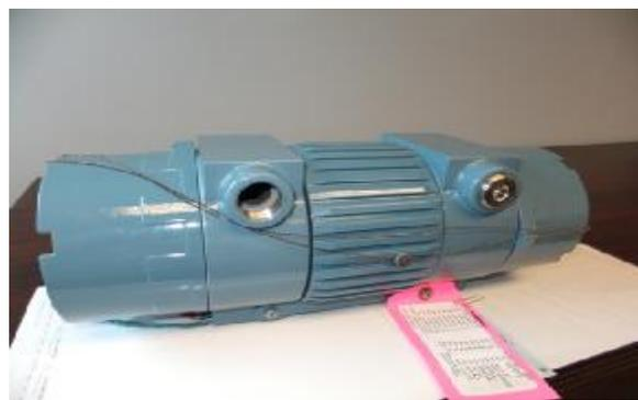
Рисунок 3 – Место пломбировки трансмиттера расходомера ультразвукового LEFM 280Ci
