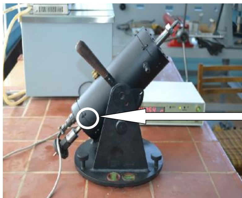
Рисунок 2 - Место пломбирования вискозиметра
