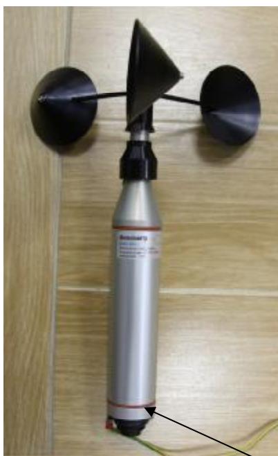
Рис. 1 Общий вид АМС-ДСВ с указанием мест пломбирования
