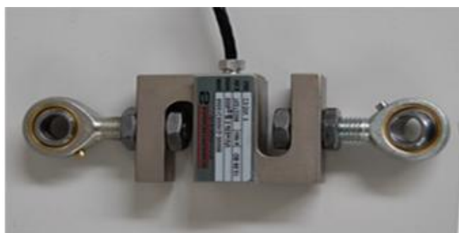
Рисунок 6 - Вид датчика семейства STC с узлами встройки
