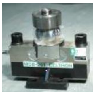
Рисунок 4 - Вид датчика семейства MDB с узлами встройки
