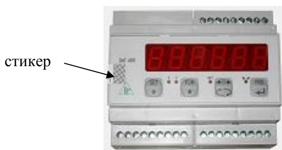
Рисунок 8 – Вид терминала MC 302 с указанием места пломбировки
