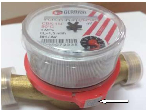
Рисунок 2 – Место пломбирования счетчиков воды крыльчатых СВК (СВК-15Х(М)(И), СВК-15Г(М)(И))
