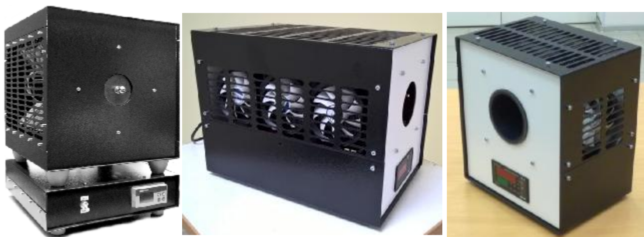
Рисунок 1 – Общий вид излучателей АЧТ -50/120 (слева направо: модификации АЧТ 60/-50/50, АЧТ 70/-40/80, АЧТ 80/-35/80)
