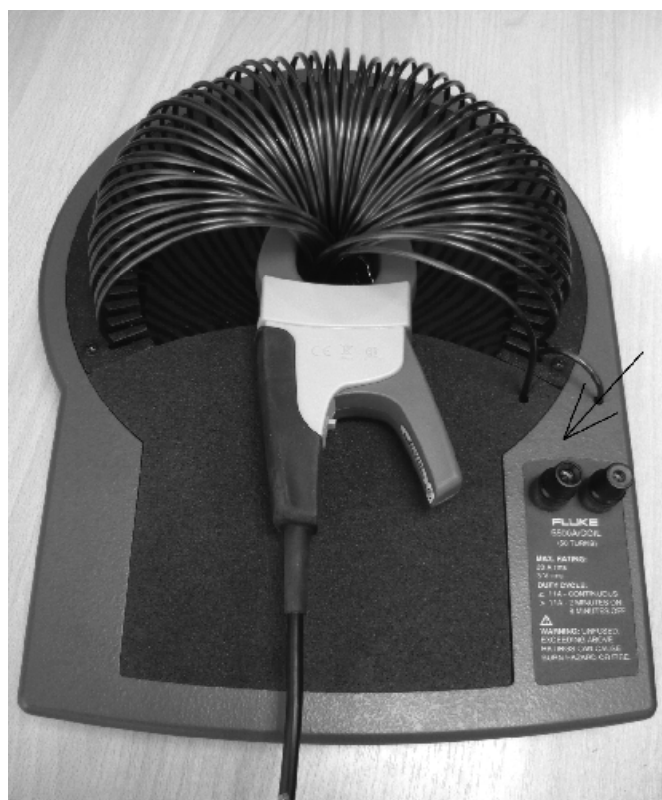
Рисунок 1 - Внешний вид катушки Fluke 5500A/COIL в процессе калибровки токовых клещей; стрелкой показано место нанесения знака утверждения типа.
