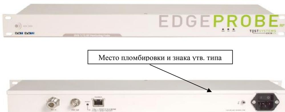
Рисунок 1 - EdgeProbe RF
