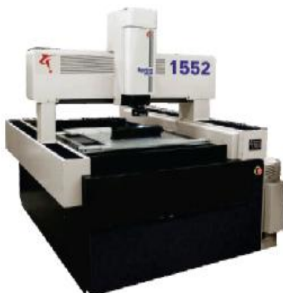
Рисунок 1 - Приборы портального типа OGP серий: а) Sprint MVP 624; б) Sprint MVP 1500,1550 и 1552; в) Zip 450 и Zip Advance 450;
