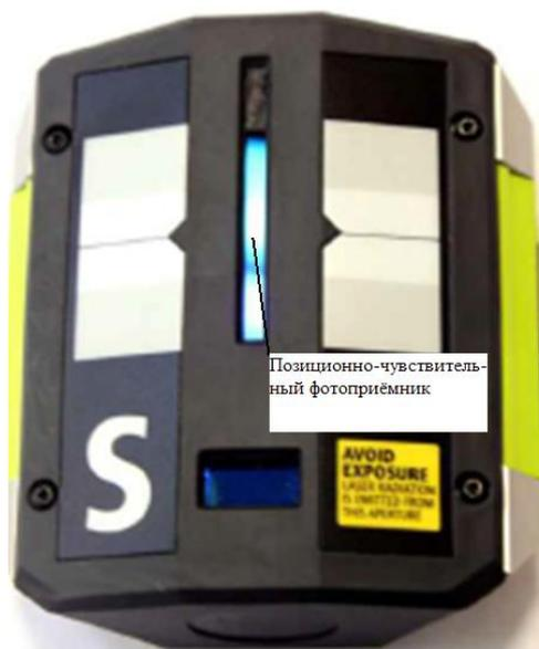
Рисунок 2 – Блок измерительный систем лазерной центровки валов серии Fixturlaser модели EVO
