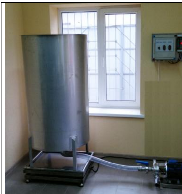
А) Вариант установки весов ВСЭ-600М с комплектом молокоприемного оборудования
