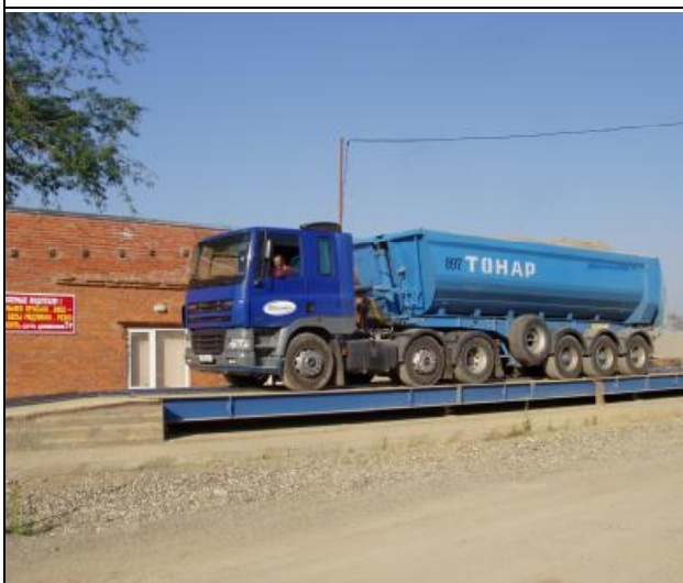
В) Вариант установки весов автомобильных ВСЭБ -80000 с пандусом
