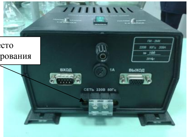
Рисунок 4 - Место пломбирования потенциостатического устройства
