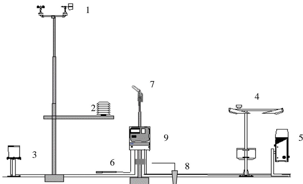
Рисунок 1 - Общий вид станций автоматических метеорологических «Сайма»
