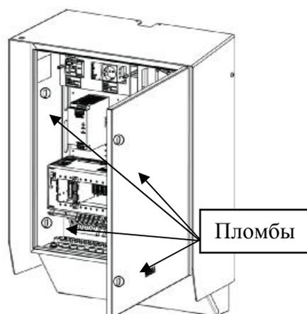
Рисунок 2 - Схема пломбирования модуля центральной системы станций «Сайма»
