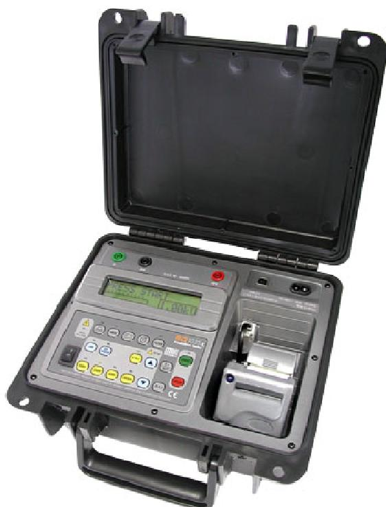
Измеритель сопротивления изоляции
