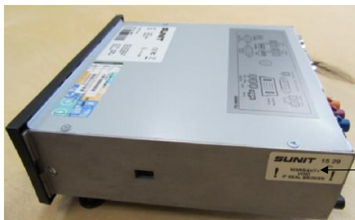
Рисунок 3– Схема пломбировки от несанкционированного доступа контроллера промышленного SunitFD2
