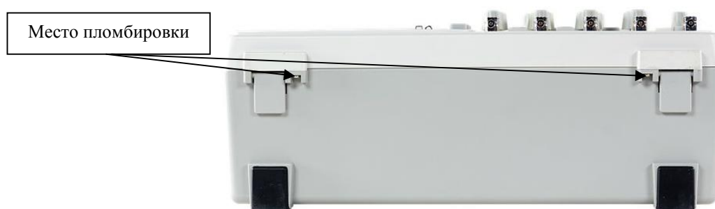
Рисунок 7 - Схема пломбировки осциллографов
