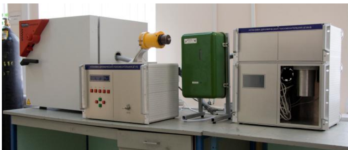
Рисунок 1 - Внешний вид рабочего эталона 1-го разряда – комплекса динамического газосмесительного ДГК-В (слева направо): термошкаф Binder, установка ДГУ-В с оптическим анализатором, искровой сигнализатор, установка ДГУН-В
