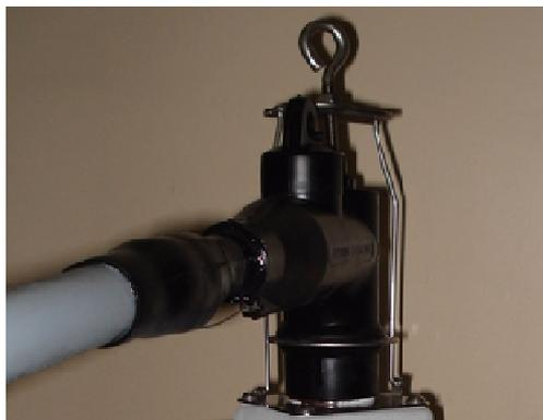
Рисунок 2 – Внешний вид высоковольтного присоединения
