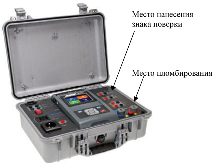
Рисунок 1 – Общий вид измерителей МІ 3394
