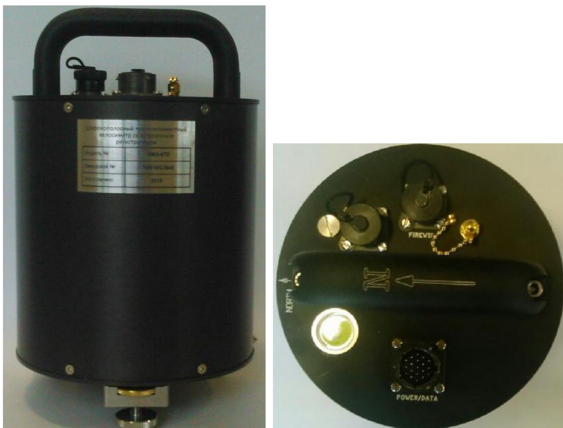
Рисунок 1 - Велосиметр широкополосный трёхкомпонентный со встроенным регистратором
