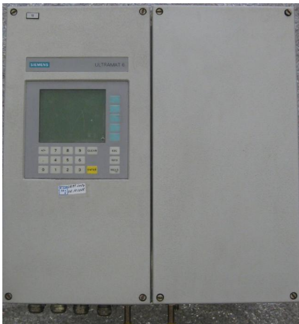
Рисунок 1 – Газоанализатор микроконцентраций оксида углерода Ultramat 6F, внешний вид
