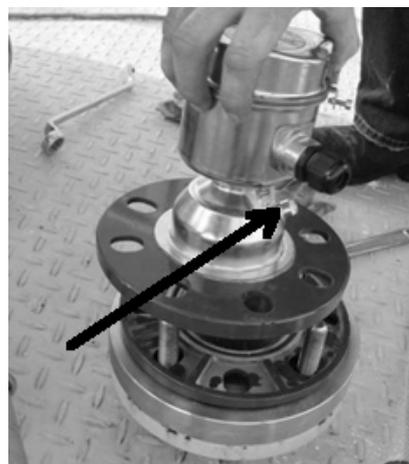
Рисунок 2 – Место пломбировки в виде наклейки
