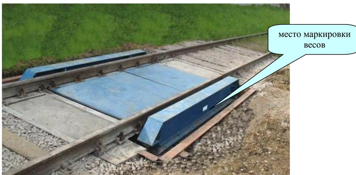
Рисунок 5 – Маркировка весов на грузоприемном устройстве
