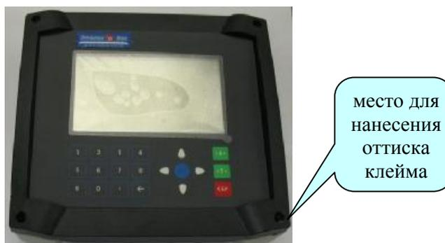
Рисунок 3 – Схема защиты от несанкционированного доступа в настройки индикатора ВУ-2010С и обозначение места для нанесения оттиска клейма
