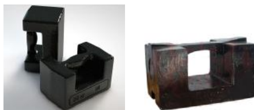
Рисунок 2 – Общий вид гирь в форме параллелепипеда с рукоятью и посадочными местами для штабелирования
