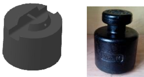
Рисунок 1 – Общий вид гирь в форме цилиндра с рукояткой и посадочными местами для штабелирования (слева) и головкой (справа)
