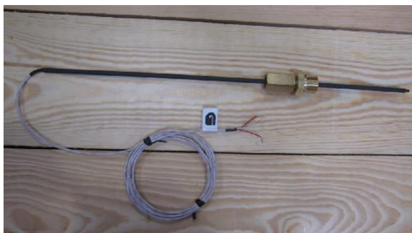
Рисунок 1 - Общий вид термопреобразователя сопротивления платинового модели К63ВН4400.2000R
