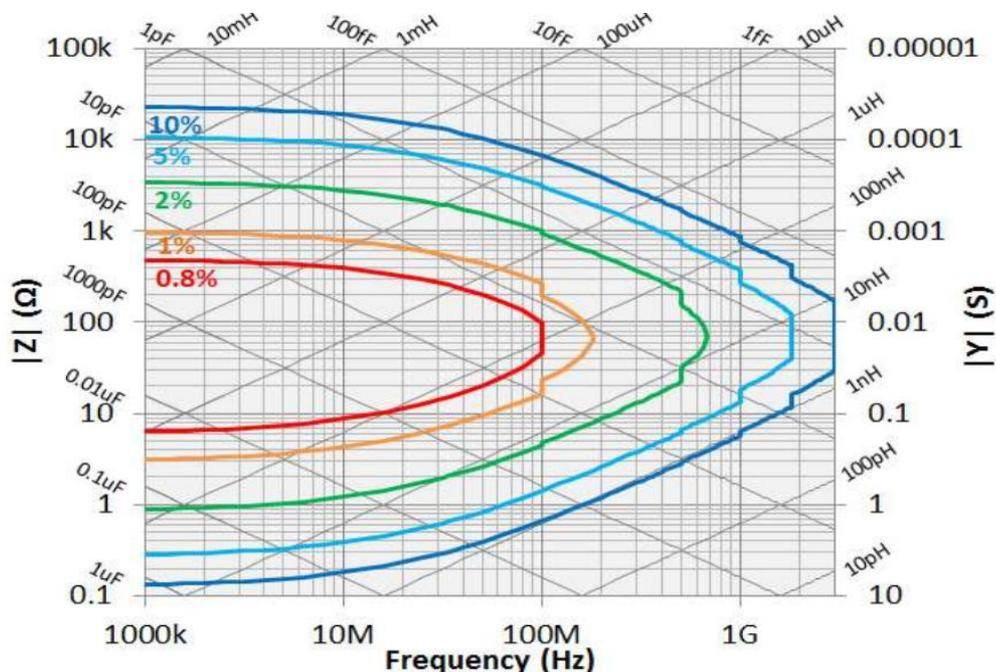
График погрешности измерения  $|Z|, |Y|$  после калибровки ХХ, КЗ и согласованная нагрузка. При выходном уровне генератора минус 33 дБм. Количество точек усреднения не менее 8. Температура окружающей среды  $23\text{ }^{\circ}\text{C} \pm 5\text{ }^{\circ}\text{C}$
