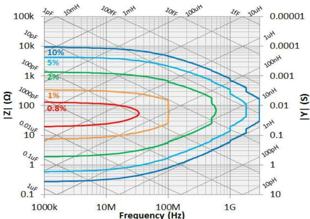
График погрешности измерения  $|Z|, |Y|$  после калибровки ХХ, КЗ и согласованная нагрузка. При выходном уровне генератора минус 33 дБм. Количество точек усреднения не более 7. Температура окружающей среды  $23\text{ }^{\circ}\text{C} \pm 5\text{ }^{\circ}\text{C}$
