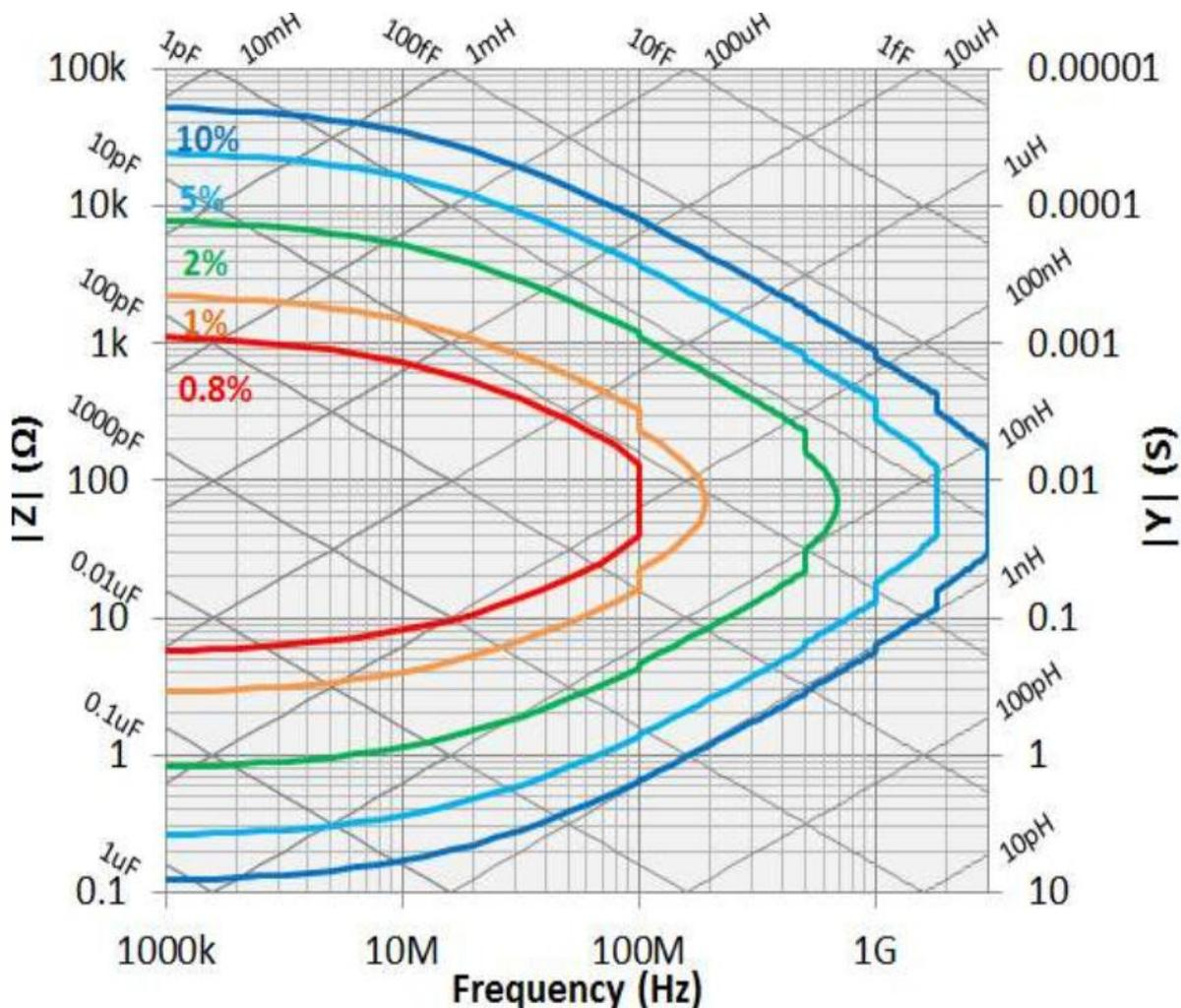
График погрешности измерения  $|Z|, |Y|$  после калибровки ХХ, КЗ и согласованная нагрузка. При выходном уровне генератора минус 13 дБм и минус 3 дБм. Количество точек усреднения не более 7. Температура окружающей среды  $23\text{ }^{\circ}\text{C} \pm 5\text{ }^{\circ}\text{C}$
