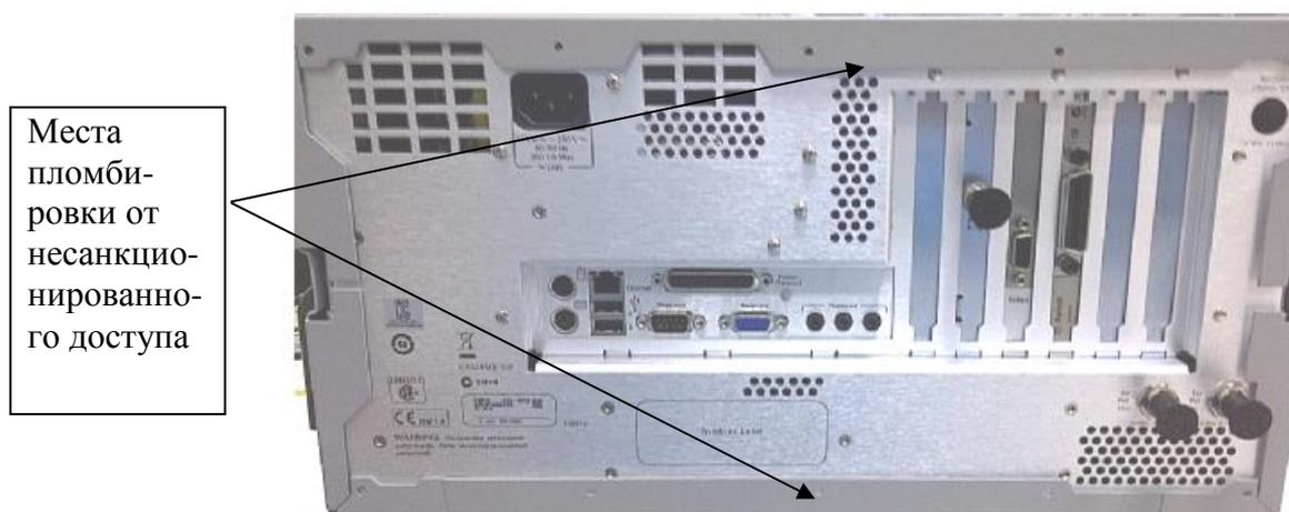
Рисунок 2 – Внешний вид задней панели измерителей
