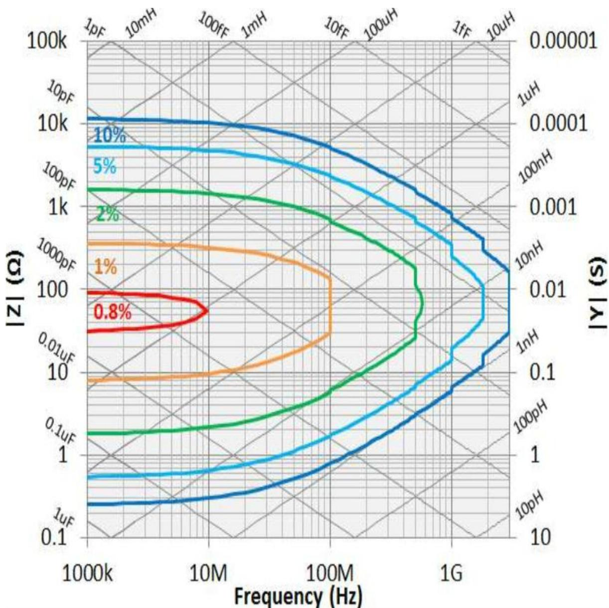
График погрешности измерения  $|Z|, |Y|$  после калибровки ХХ, КЗ и согласованная нагрузка. При выходном уровне генератора минус 13 дБм и минус 3 дБм. Количество точек усреднения не более 7. Температура окружающей среды  $23\text{ }^{\circ}\text{C} \pm 5\text{ }^{\circ}\text{C}$
