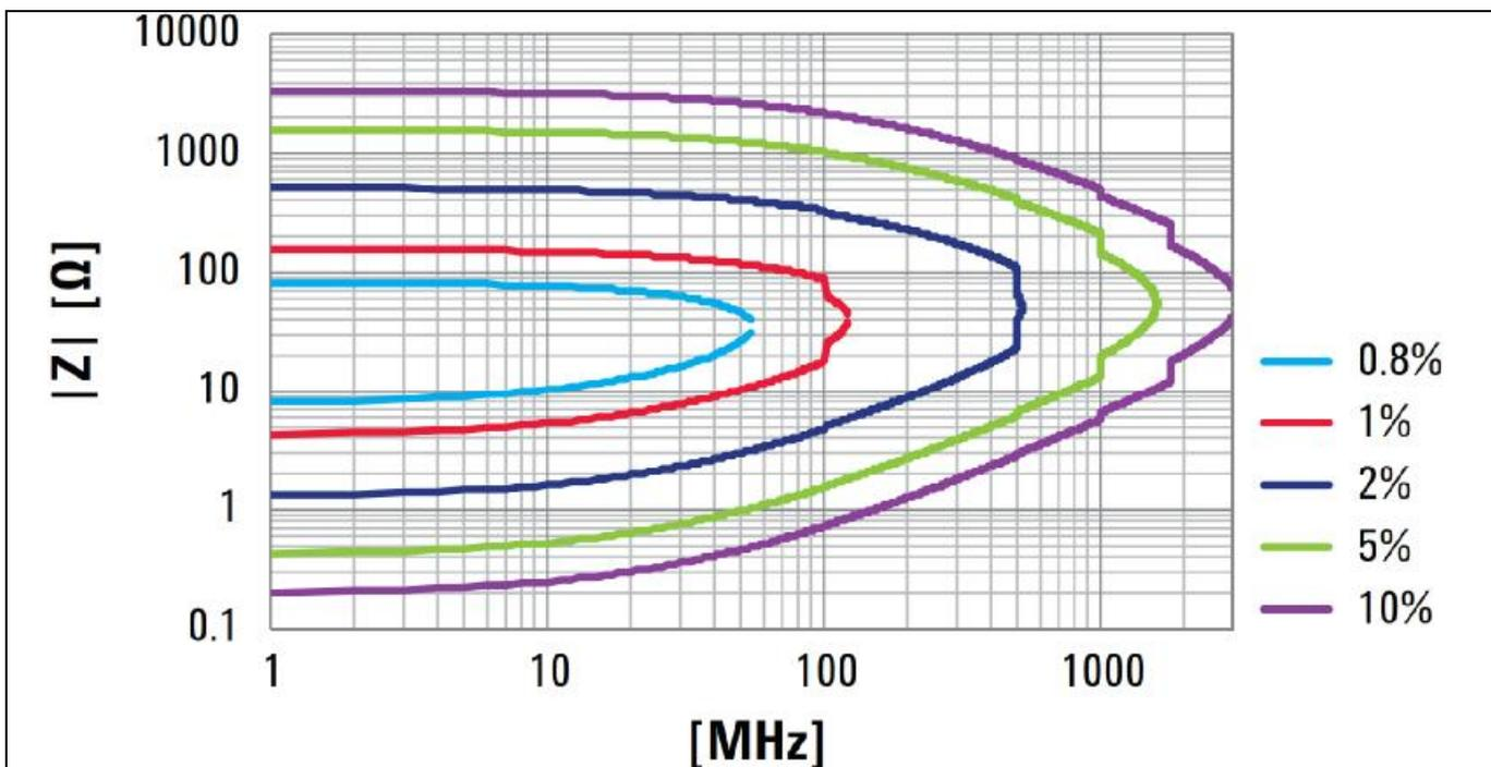
Скорость измерений: Режим 1; выходной уровень генератора 1 дБм; количество точек усреднения – менее 8
