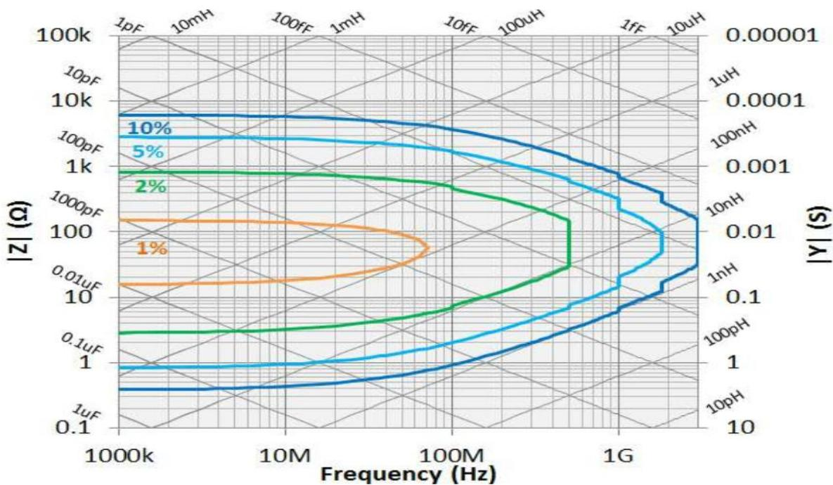
График погрешности измерения  $|Z|, |Y|$  после калибровки ХХ, КЗ и согласованная нагрузка. При выходном уровне генератора минус 33 дБм. Количество точек усреднения не более 7. Температура окружающей среды  $23 \text{ }^\circ\text{C} \pm 5 \text{ }^\circ\text{C}$
