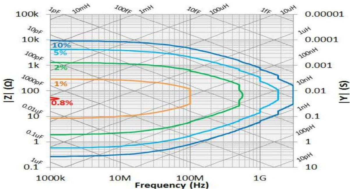
График погрешности измерения  $|Z|, |Y|$  после калибровки ХХ, КЗ и согласованная нагрузка. При выходном уровне генератора минус 33 дБм. Количество точек усреднения не менее 8. Температура окружающей среды  $23\text{ }^{\circ}\text{C} \pm 5\text{ }^{\circ}\text{C}$
