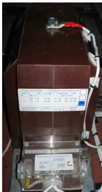
Высоковольтный вывод «А» первичной обмотки расположен в верхней части корпуса и выполнен в виде контакта под болт М10.
