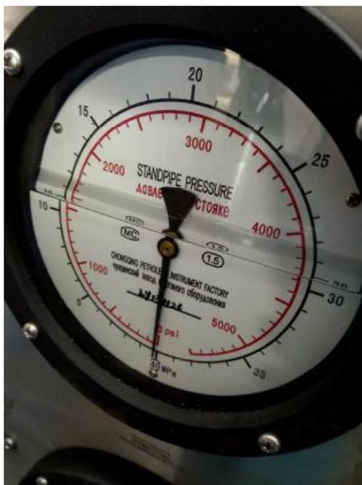
Рисунок 1 – Общий вид манометров избыточного давления СУ20020А
