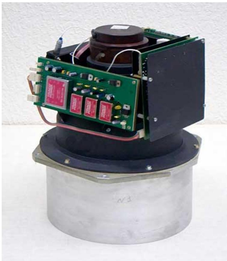
Рисунок 5 - Внешний вид блока детектирования комплекса NaI ПАК-0-СДН.30.200.100 с установленными на время лабораторных испытаний вспомогательными устройствами
