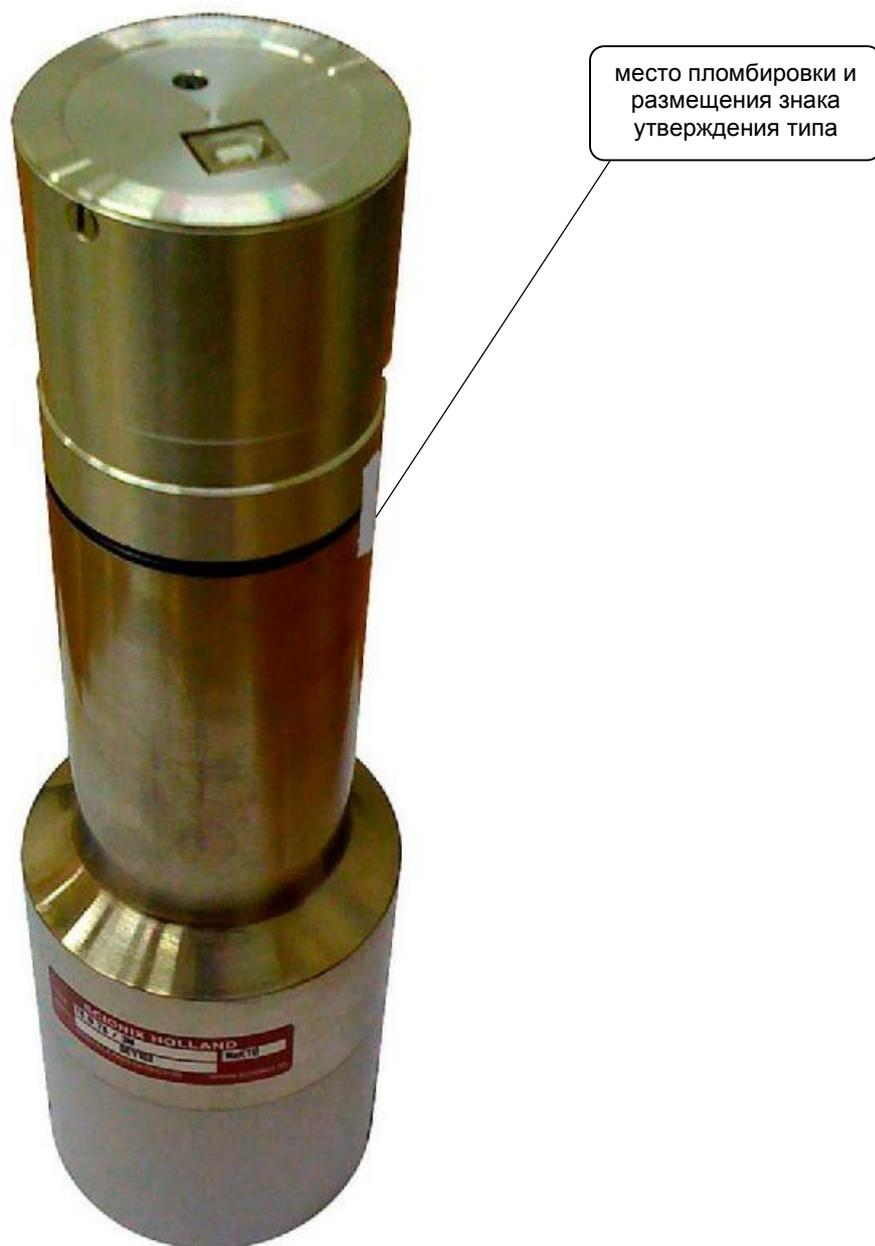
Рисунок 2 - Блок детектирования комплекса NaI ПАК-0-76В76/3М
