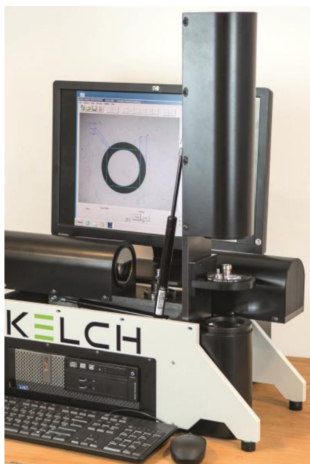
Рисунок 3 – Общий вид машины измерительной Kenova Measure Line модификаций VNE 2117 и VNE 4334
