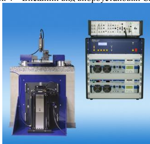
Рисунок 4 – Внешний вид виброустановки CS18 VLF
