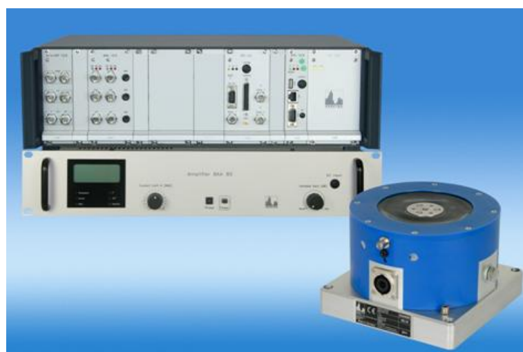
Рисунок 3 – Внешний вид виброустановки CS18 MF
