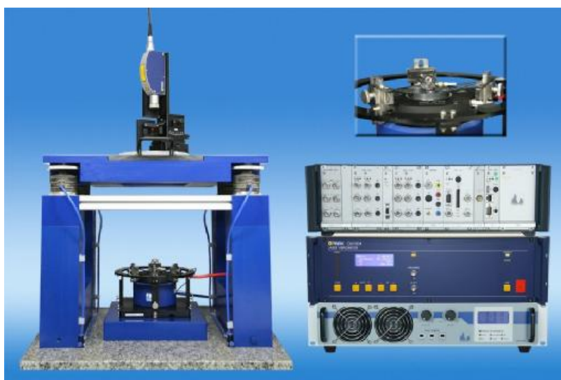
Рисунок 2 – Внешний вид виброустановки CS18P HF
