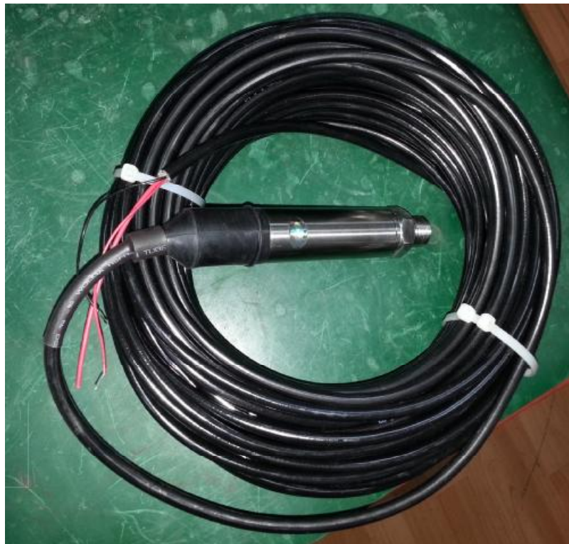
Рисунок 1 – Датчики давления ЮВ-К
