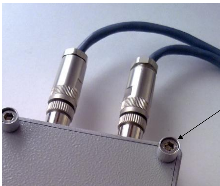
Рисунок 3 - Вид отсека печатной платы измерителей сопротивлений МИС с указанием места установки мастичной пломбы
