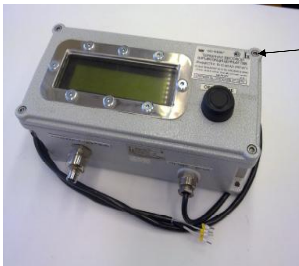
Рисунок 1 - Общий вид терминала весового взрывозащищенного ТВВ
