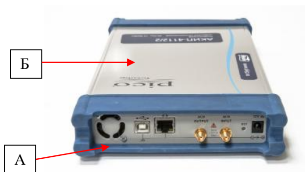
Рисунок 2 – Схема пломбировки от несанкционированного доступа (А) и нанесения знака поверки (Б)
