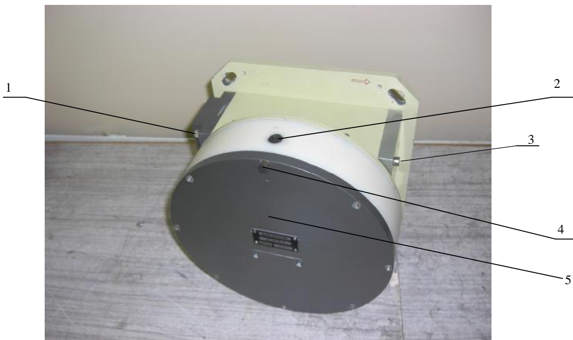
1, 2, 3, 4 – места пломбировки 5 – место нанесения знака утверждения типа Рисунок 2 – Внешний вид ПУ-М с указанием мест пломбировки от несанкционированного доступа и знака утверждения типа
