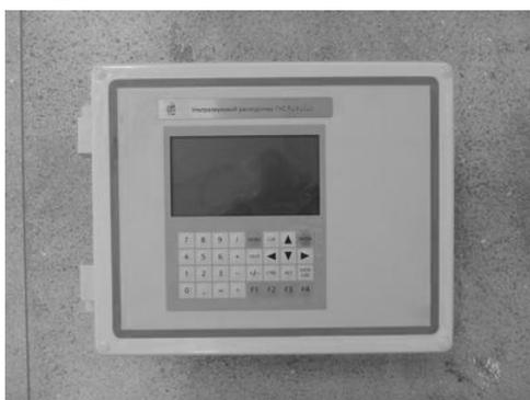
а) Внешний вид стационарного вычислителя расходомера ГКС FUX1010 в корпусе NEMA 4X
