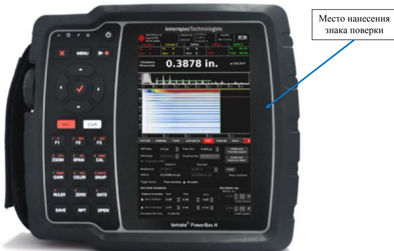
Рисунок 1 – Общий вид толщиномера с обозначением места нанесения знака поверки Совместно с толщимером применяются ЭМАП производства компании Innerspec Technologies, Inc. (США).
