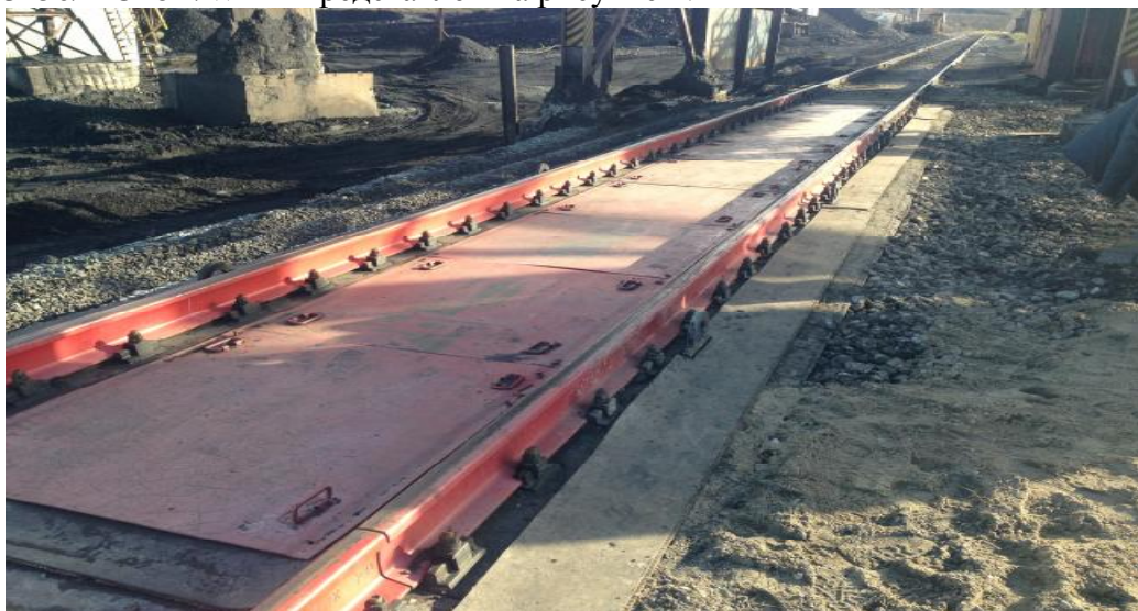
Рисунок 1 - Общий вид весов СИБИРЬ-С150/2-С16А/WE-F
