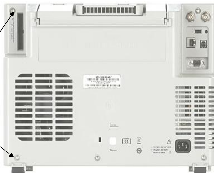
Рисунок 2 - Схема пломбировки от несанкционированного доступа
