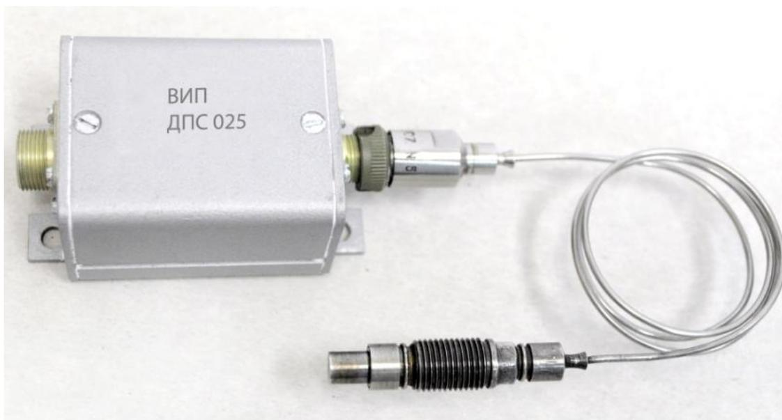
Рисунок 1 - Общий вид датчика давления ДПС 025
