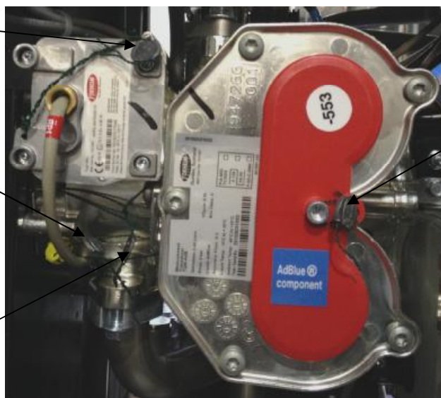
Рисунок 2 – Пломбирование измерителя объема TQM-AdB
