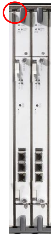
Фото 2 – Карты коммутации и управления (выделено место блокировки)
