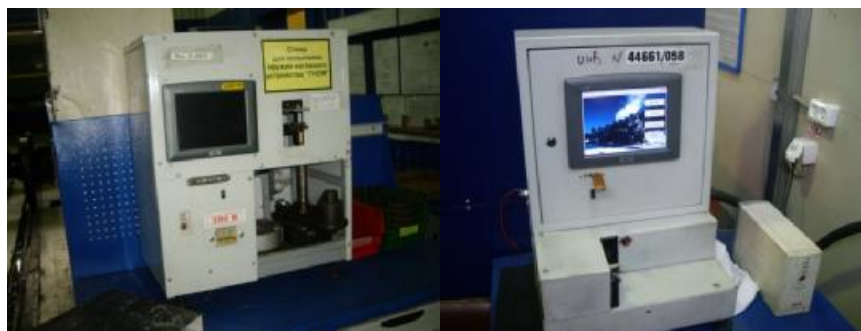
Рисунок 1 – Общий вид Стенда автоматизированного испытаний и измерений пружин «ГНОМ» и «ГНОМ-1»
