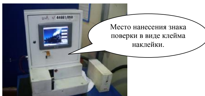
Рисунок 2 – Место нанесения знака поверки в виде клейма-наклейки
