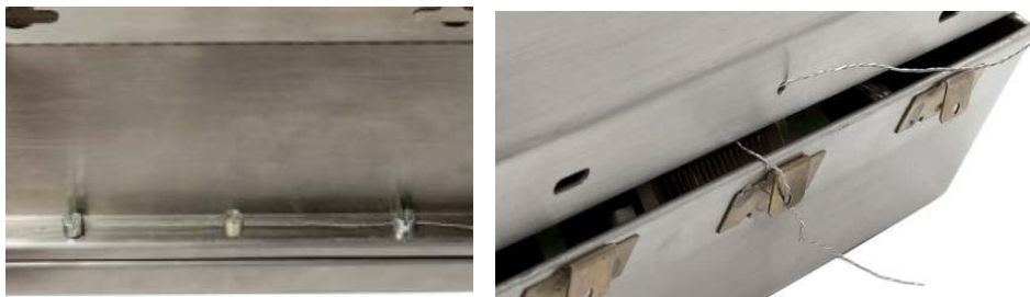
Рисунок 3 – Места пломбирования корпуса терминалов
