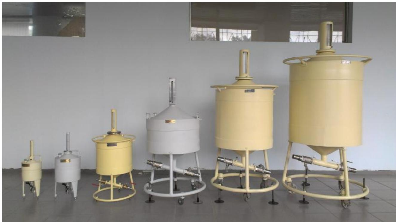
Рисунок 1 – Общий вид мерников металлических эталонных 1-го разряда М1р
