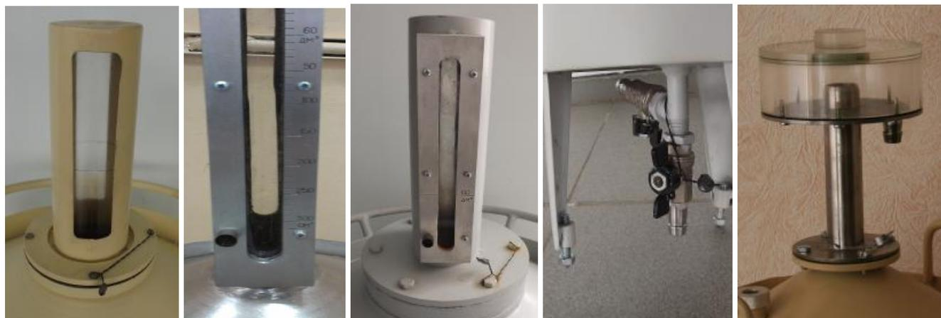
Рисунок 3 – Места пломбирования мерников металлических эталонных 1-го разряда M1p
