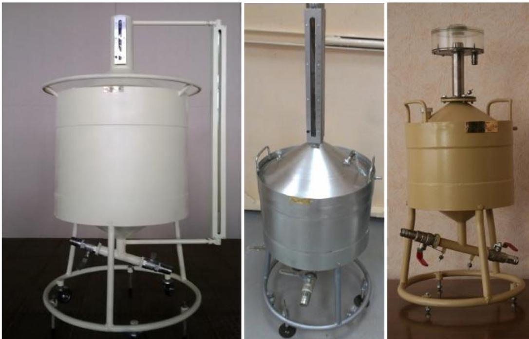
Рисунок 2 – Общий вид мерников металлических эталонных 1-го разряда М1р
