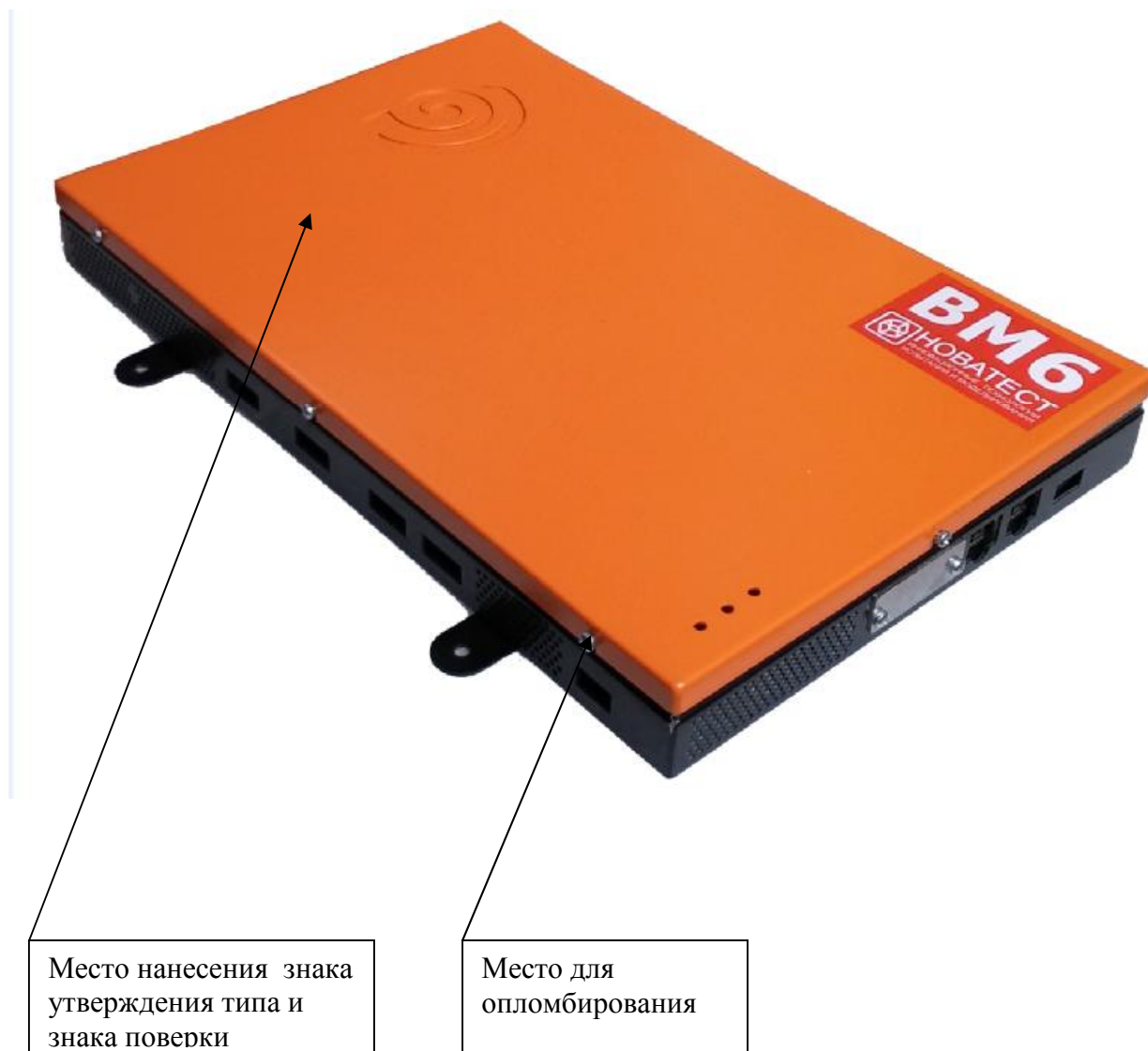
Рисунок 1 - Внешний вид аппаратуры измерения вибрации, мониторинга и защиты промышленного оборудования BM6
