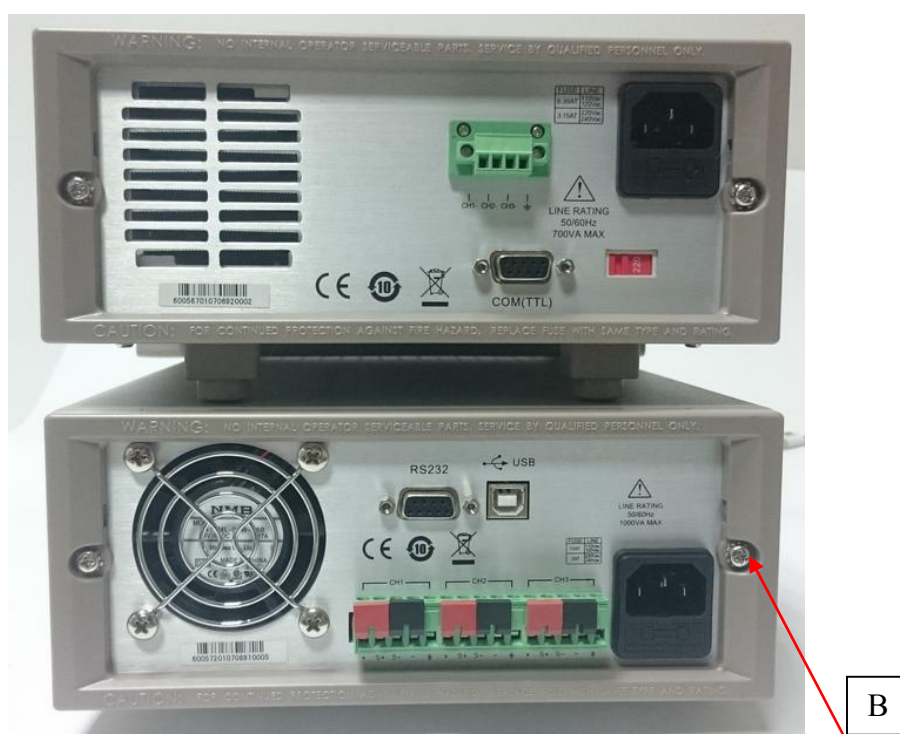
Рисунок 2 – Вид задней панели источников, место пломбировки от несанкционированного доступа (Б)
